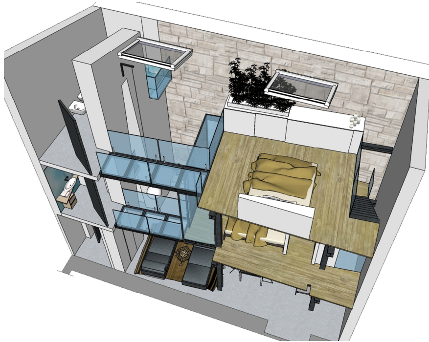
Fig. 4. Progetto virtuale dei tre livelli sovrapposti della prima unità realizzata.
