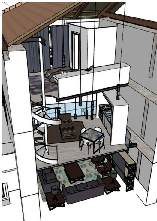
Fig. 5. Progetto della seconda unità edilizia con impalcati sfalsati.
